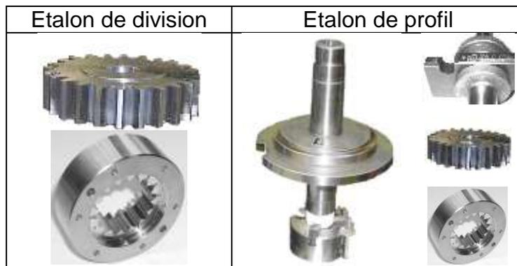
Figure 12 : Etalons de profils et de division mesurés
