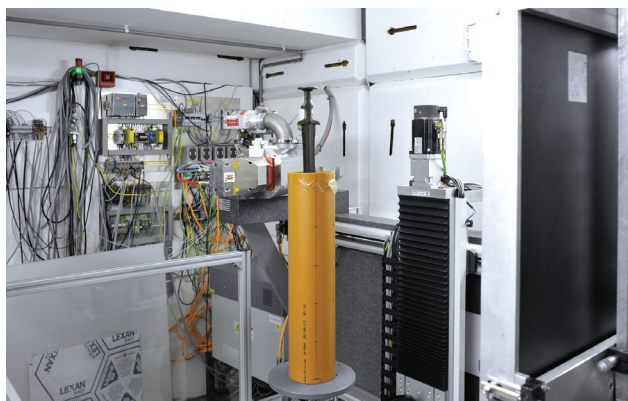
Fig. 2. Réalisation d'une tomographie sur une copie d'épée de l'âge du Bronze (Stadsmuseum de la ville de Gand) à l'UGCT. © Léonard Dumont.
