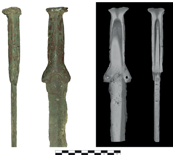
Fig. 3. Coupes coronale et sagittale à travers la partie supérieure d'une épée de provenance indéterminée (Bruxelles, musées royaux d'art et d'histoire, n° B 320). © Photos et traitement Léonard Dumont et Tim De Kock/Ugct.
