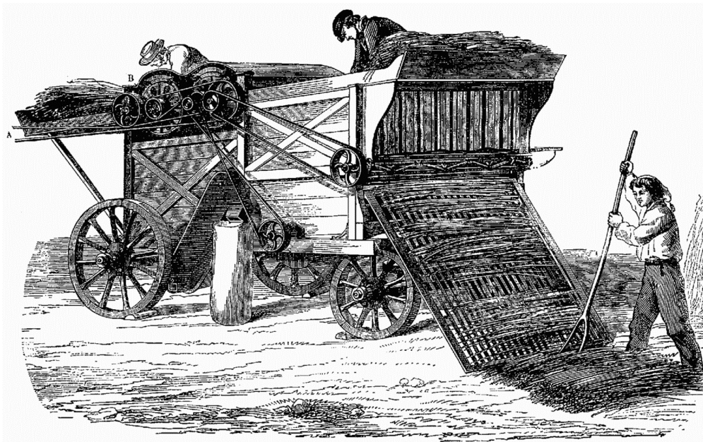
Fig. 5. – Machine à battre les gerbes à grains relié à une locomobile à vapeur. « Les locomobiles », in Louis Figuiet, Les Merveilles de la science ou description populaire des inventions modernes , Paris, Furne, Jouvot et Cie, 1867, t. 1, p. 412.
