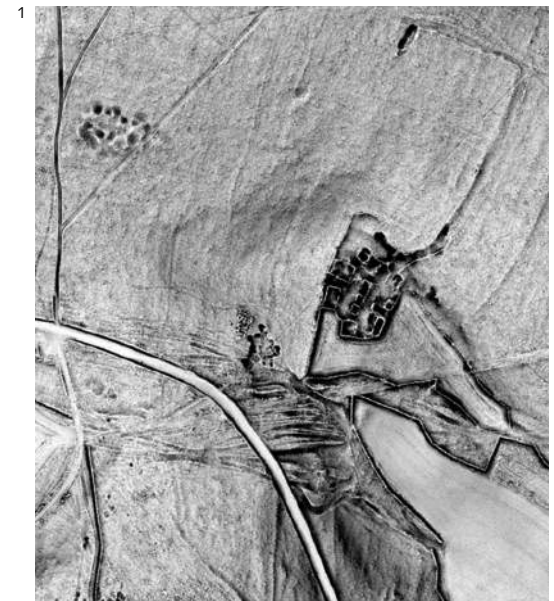
Le LiDAR (Light Detection and Ranging) ou lasergrammétrie aéroportée est une méthode de relevé détaillé des reliefs du sol. Depuis un avion, un scanner-laser balaye le sol, même à travers les feuilles des arbres, et enregistre les échos réfléchis par les obstacles. Des traitements informatiques ne sélectionnant que le dernier écho, au niveau du sol, produisent un MNT (Modèle Numérique de Terrain) à partir duquel des algorithmes permettent d'obtenir une image reflétant précisément les microreliefs ; ici procédé "sky view factor". C'est une méthode très performante pour repérer les aménagements humains sous couvert forestier.
