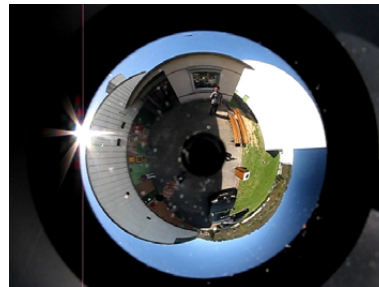
(b) Image obtenue avec une caméra catadioptrique
