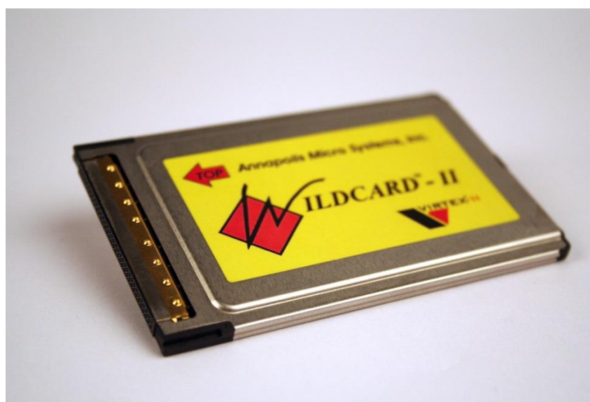
Figure 8 : Une PC-card à base de FPGA – La Wildcard
