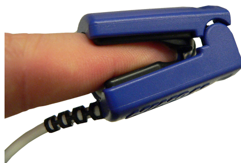
FIGURE 2.10 – Un exemple d'oxymètre utilisé pour la mesure de la saturation en oxygène (Source : Rama on Wikimedia CeCILL).
