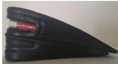
Figure 3.4: Semelle de rembourrage de 7cm de haut permettant de simuler une personne qui boite.
