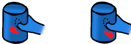
Figure 6.2: Comme il n’y a pas de retour haptique, la main virtuelle (issue du suivi de la main réelle) peut chevaucher le volume de l’objet virtuel (à gauche). La position estimée de la main sera donc modifiée en conséquence. Mais lorsque la personne ouvre de nouveau la main (à droite), cela revient à un retour à la position estimée et non à un relâchement de l’objet.
